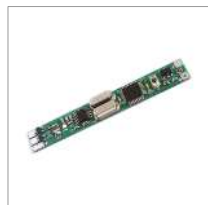
LED receiver basic 1 channel moduł sterujący LED podstawowy 1-kanalowy 12-24 V; 60-100 W
